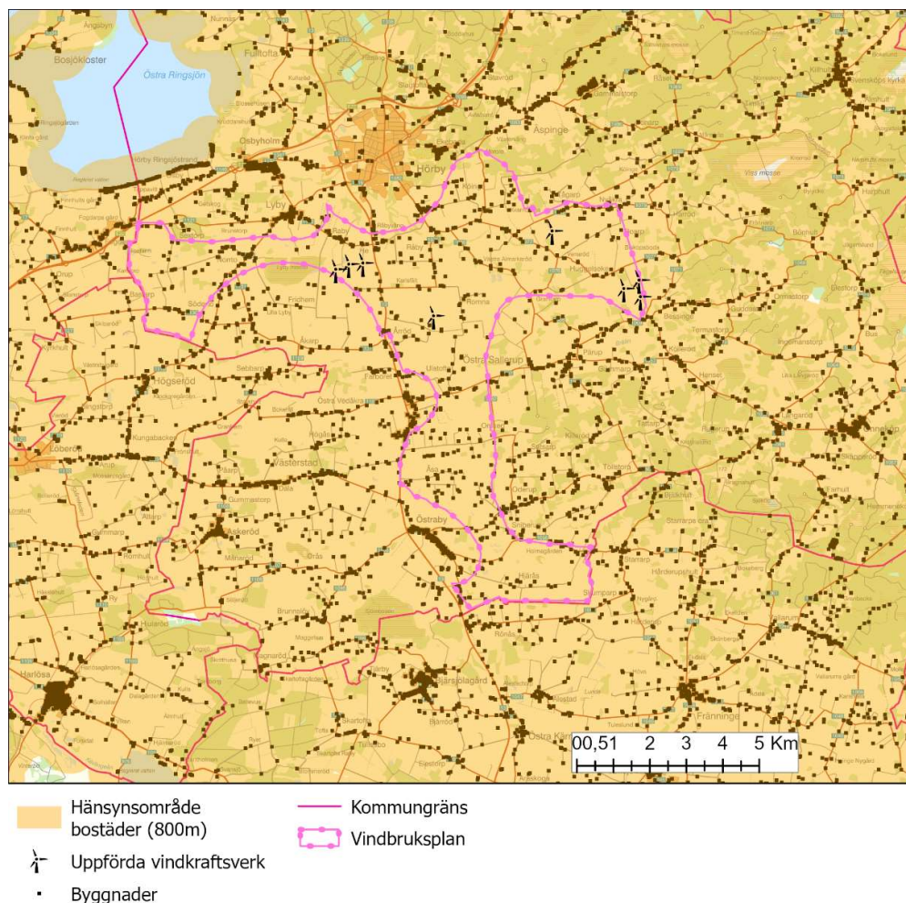
Figur 5. Hörbys vindbruksplan, byggnader, samt skyddsavstånd till dessa.
